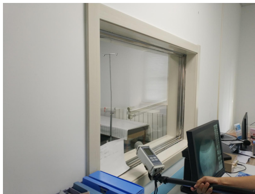
III类射线装置机房监测
